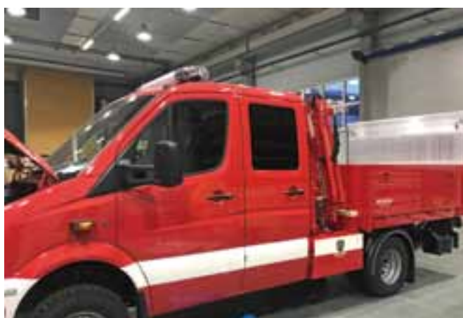
Die Firma Ressenig integrierte den vorhandenen Ladekran des Typs Palfinger PC2300 in den Aufbau.
