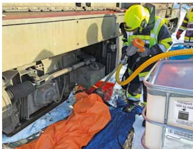
Der defekte Betriebstank wurde mit einer speziellen Leckdichtpaste provisorisch abgedichtet.
