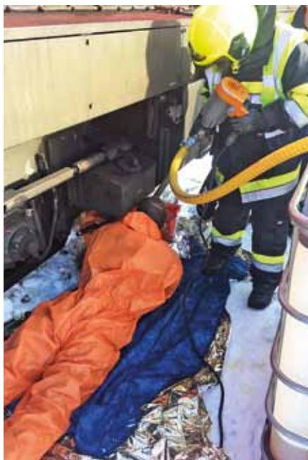
rann Diesel auf den Gleiskörper. Das Leck konnte rasch mit einer speziellen Leckdichtpaste notdürftig abgedichtet werden. Der restliche Diesel wurde mit einer sogenannten Fasspumpe in einen Auffangbehälter umgepumpt. Der bereits ausgetretene Treibstoff konnte mit flüssigem Bindemittel behandelt werden.
