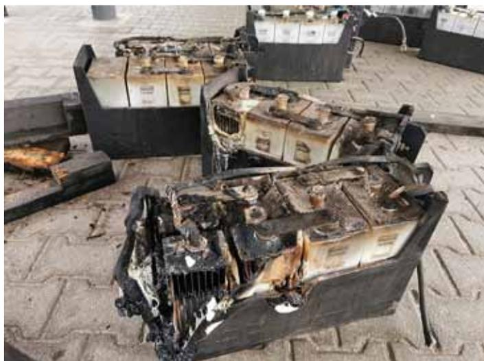
Einige der durch den Brand zerstörten Batterien wurden ausgebaut und in weiterer Folge in einem Wasserbad zum Kühlen gelagert.
