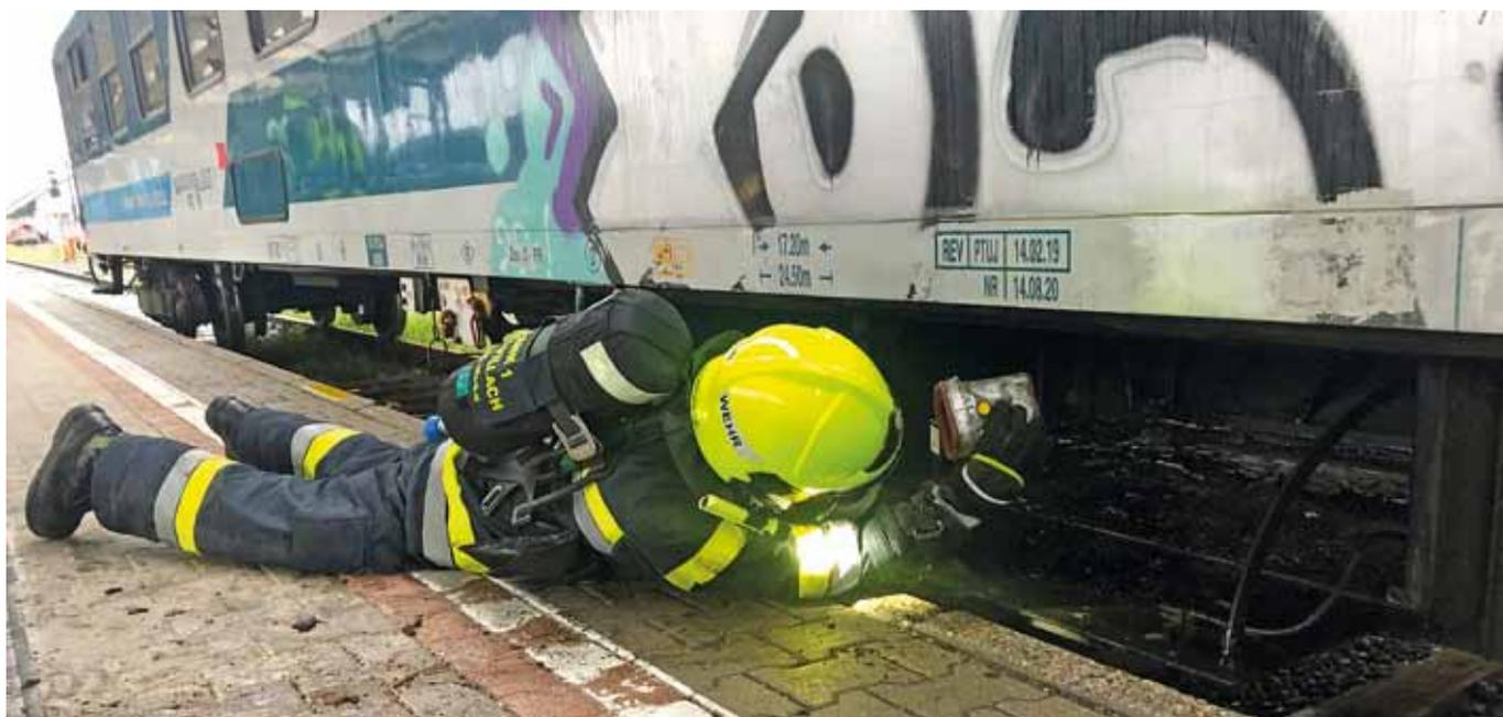
Mit der Wärmebildkamera wurden alle Batteriefächer, Anbauteile und nicht einsehbare Hohlräume auf Glutnester und gefährbringende Erwärmung kontrolliert.
