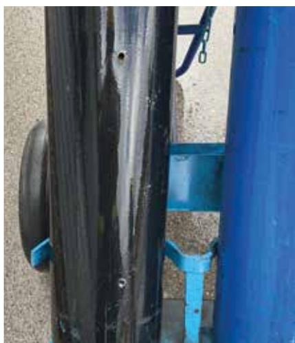
Gut sichtbar die Leuchtspurmunition durchschlug ohne Probleme die Stahlaußenhaut der Gasflasche.
