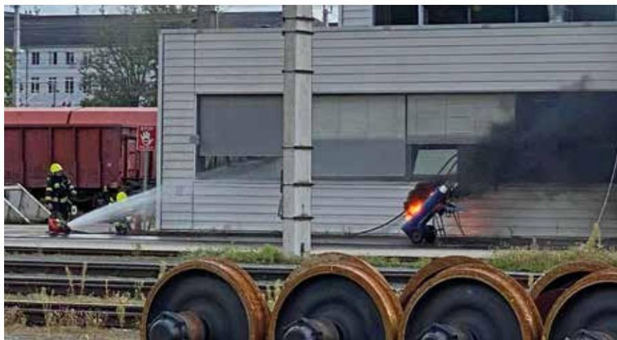
Nach dem Beschuss verbrannte das Acetylen gas mit einer orangegelben Flamme und einer starken Rauchentwicklung. Über den Bodenwerfer wurde der Flaschenwagen gekühlt.
