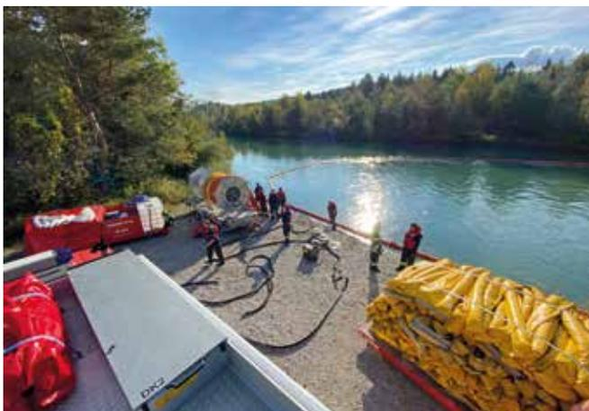
Einsatz unserer Schadstoffsperrern in Verbindung mit den erforderlichen Gerätschaften zum Abpumpen des Gefahrstoffs.
