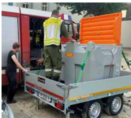
Mit unserer mobilen Dieseltankstelle konnten viele Geräte und Fahrzeuge vor Ort betankt werden.
